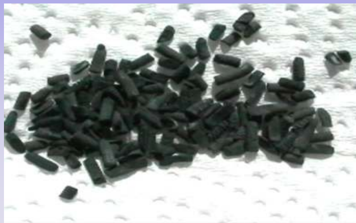
Κεραμικοί μονόλιθοι ( \text{SiO}_2\text{-Al}_2\text{O}_3\text{-MgO} )
