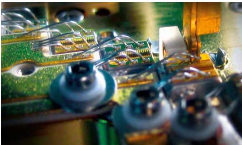
Fig. 4.2.9 Fibre-coupled diode laser © Fraunhofer-Institut für Lasertechnik
