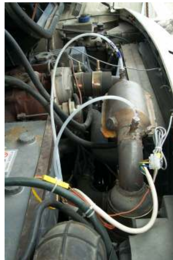
Σύστημα μέτρησης της ροής του αέρα εισαγωγής
