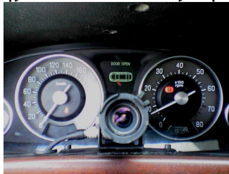
Ο αισθητήρας παρακολούθησης των οφθαλμών του οδηγού
