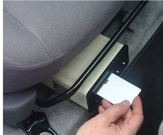
ΕΙΚΟΝΑ 5-8: Σύστημα καταγραφής δεδομένων οδήγησης και κατανάλωσης
