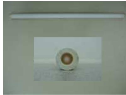
Σχήμα 3. Δεξιά: Φωτογραφία της πειραματικής μονάδας Αριστερά: Φωτογραφία δοκιμίου κεραμικής πολυστοιβαδικής κυλινδρικής μεμβράνης
