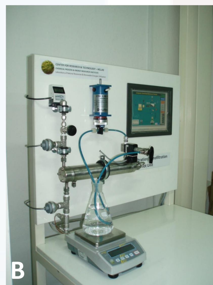
Σχήμα 1. Πιλοτικό σύστημα εφαιπτομενικής UF/NF διήθησης. Α) Σχηματική παράσταση, Β) Φωτογραφία
